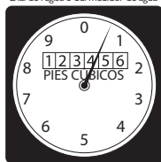
Dial de registro del medidor de agua
